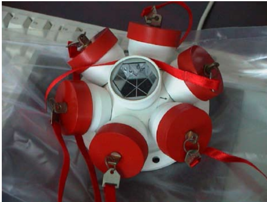
Bild 4: Laser Reflektoren, „Satellite Laser Ranging“
