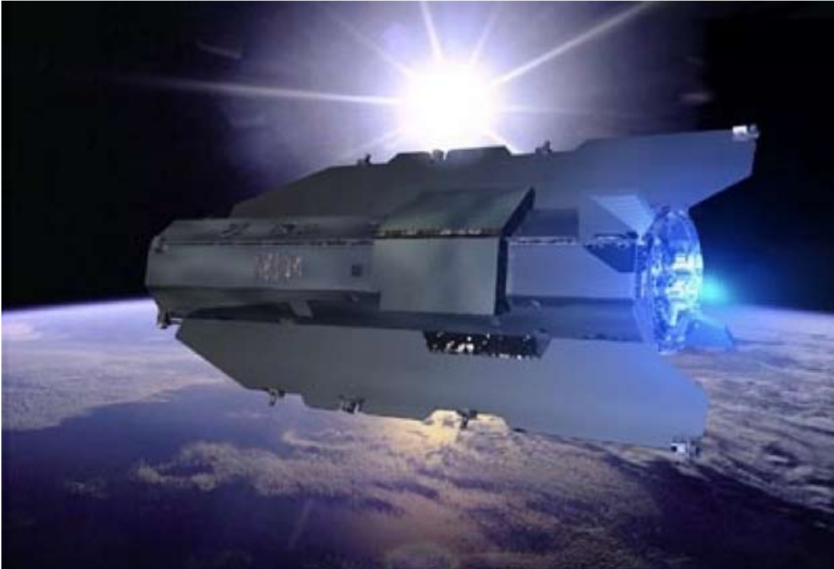
Bild 9: Zielvorstellungen, „Gravity and Steady-State Ocean Circulation Explorer“ (GOCE), (i) Geoid-Höhen, (ii) relative Genauigkeit 1ppm, (iii) räumliche Auflösung von 100 km: n(\text{max}) = 200
