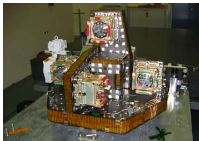
Bild 5: einzelner Beschleunigungsmesser, einachsiges Gradiometer, dreiachsiges Gradiometer
